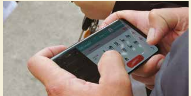
L'application de Classement par Étoiles pour Écoles de l'iRAP génère des données identifiant la conception dangereuse des rues et les limites de vitesses inappropriées sur les trajets vers l'école.
